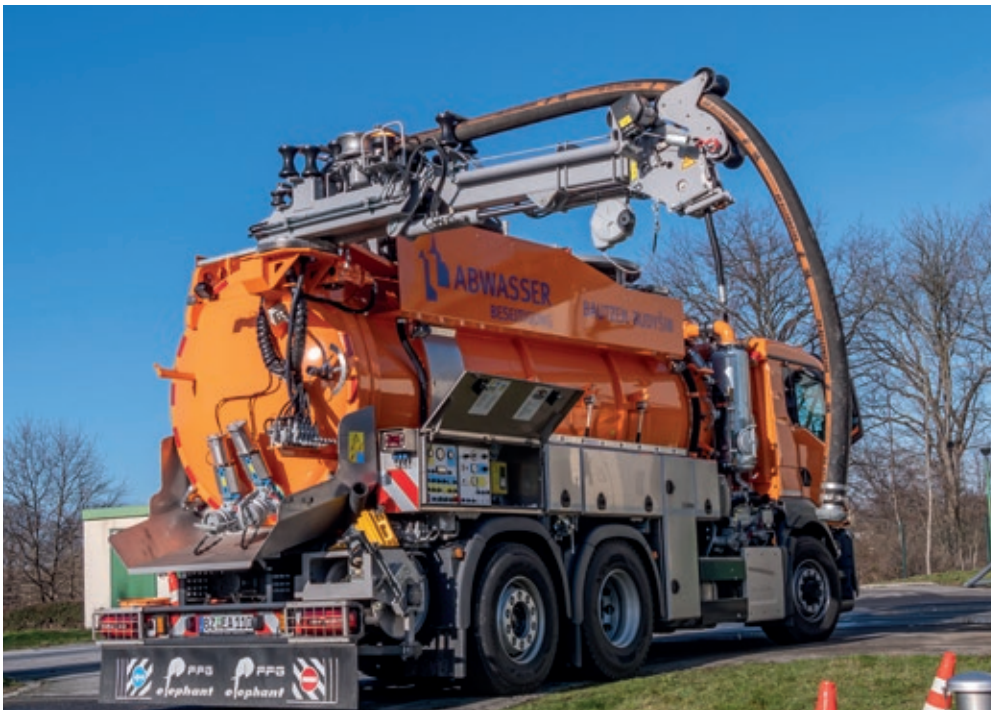
High Tech mit 430 PS: Das neue Saug- und Spülfahrzeug des EAB.
