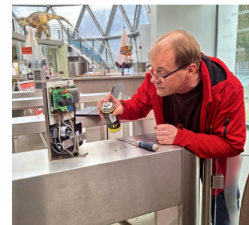
Jedes Detail zählt: André Förster wartet mit großer Sorgfalt die Vereinzelungsanlage am Eingang des Saurierparks. Damit die Technik reibungslos funktioniert, werden alle Bauteile gründlich geprüft, gereinigt und justiert – für einen störungsfreien Start in die neue Saison.
